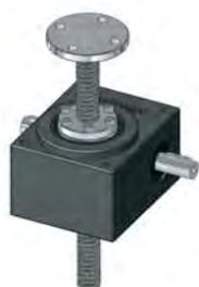
Martinetto con asta a ricircolo di sfere a spostamento assiale. La rotazione della vite senza fine si trasforma in uno spostamento lineare dell'asta a ricircolo di sfere, che deve avere un contrasto alla rotazione.
