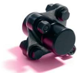
La resistenza agli agenti corrosivi, l'assorbimento delle vibrazioni, l'utilizzo in qualunque condizione di temperatura e una durata pressoché illimitata senza alcun tipo di manutenzione li rendono un prodotto eccellente. La costruzione dei giunti Unimec prevede una costruzione completamente metallica in acciaio stampato; il pacco lamellare è realizzato in acciaio per molle.
