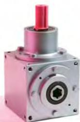
e la possibilità di connessione diretta a qualsiasi tipo di motore, dai normati IEC ai brushless, ai pneumatici e così via. Alti rendimenti e silenziosità sono la logica conseguenza dell'utilizzo di ingranaggi conici a dentatura spirooidale Gleason®; l'utilizzo di questo tipo di geometria e i trattamenti termici adottati pongono i rinvii angolari UNIMEC ai vertici di questo settore della meccanica.
