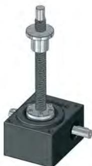
Martinetto con asta a ricircolo di sfere rotante. La rotazione della vite senza fine si trasforma in una rotazione dell'asta a ricircolo di sfere. Lo spostamento del carico è affidato alla madrevite, che deve avere un contrasto alla rotazione.
